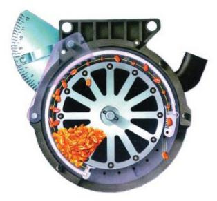
Dosificador neumático MATERMACC con patente internacional que distribuye semillas de diferentes tamaños sin cambio del disco. La semilla se mantiene en el hueco por la acción del vacío y se suelta en el punto exacto para que caiga al tubo de salida.
